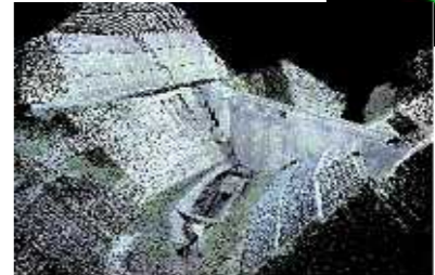
ダムの3次元レーザースキャンデータ
